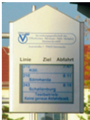
Solarbetriebene Fahrgastinformationsanzeige, hier an der Haltestelle Sömmerda, Böblinger Platz
